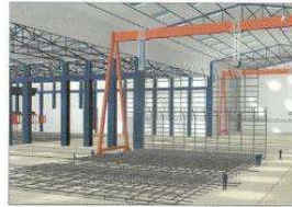
Armeringen förtillverkas i enheter och flyttas till gjutavdelningen.
